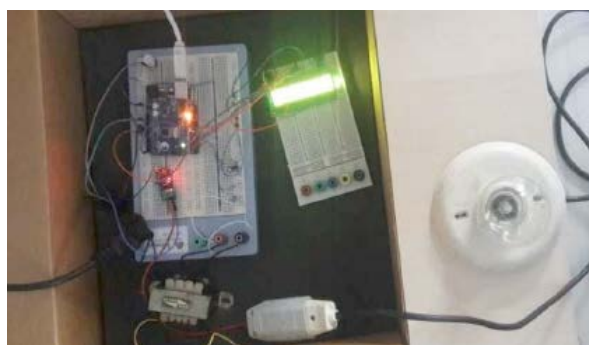
Figura 3 – Medidor de corrente e tensão elétrica.
