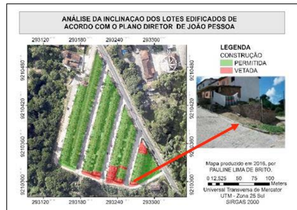
Figura 16 – Mapa de inclinação do terreno de acordo com o Plano Diretor de João Pessoa (2009)
