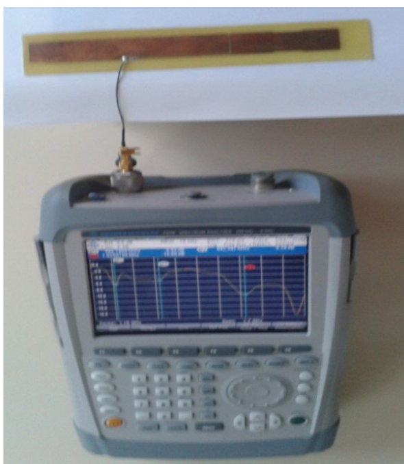
Figura 10 – Medição da antena confeccionada.
