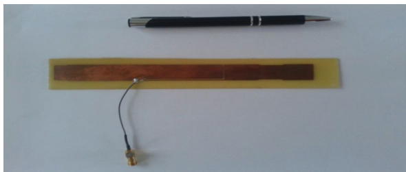
Figura 9 – Antena confeccionada e conectorizada.
