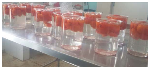
Figura 2 – Tomates durante o processo de desidratação osmótica para os 13 tratamentos
