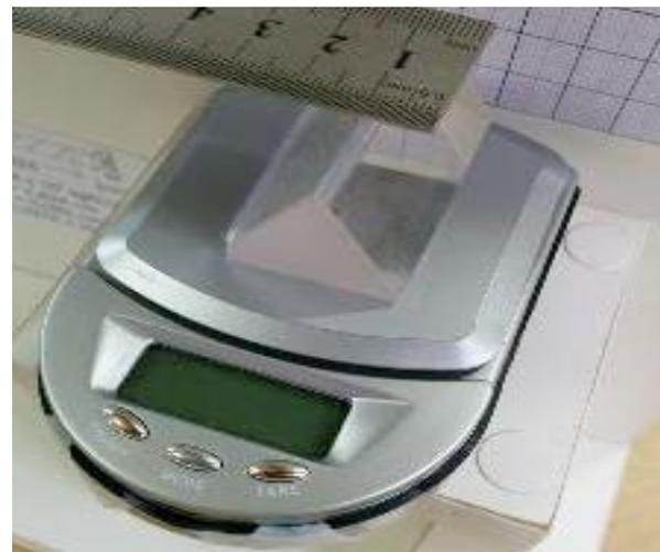
**Figura 6** – Medição da reação de apoio com a balança.
