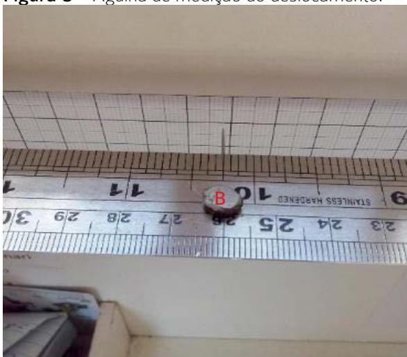
Na Figura 9 é ilustrado-o modelo finalizado com uma carga concentrada no suporte central (ponto B), onde é possível observar que a deformada da viga se assemelha muito a obtida analiticamente (ilustrada na Figura 1), com uma tangente horizontal próxima ao apoio engastado, e a rotação livre no apoio rotulado.
