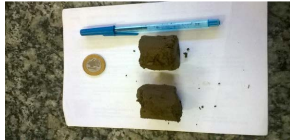
Figura 8 – Parte da amostra de solo colhida no ensaio SPT.
