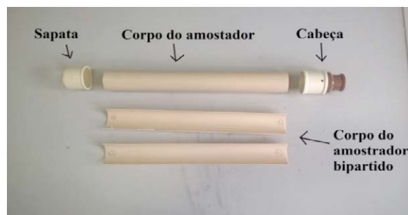
Figura 6 – Amostrador-padrão do modelo didático reduzido.
