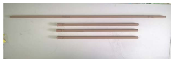
Figura 4 – Hastes da composição de perfuração e de cravação do modelo didático reduzido.
