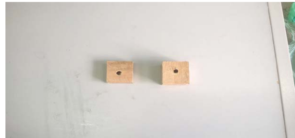
Figura 3 – Cabeça de bater e coxim do modelo didático reduzido.
