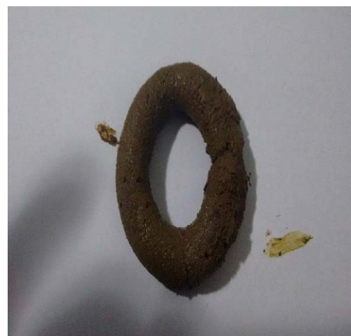
Figura 9 – Teste de plasticidade com a amostra de solo.
