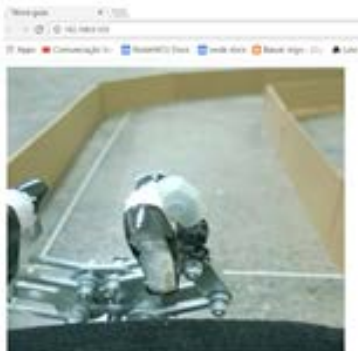
Figura 7 – Tela com feedback de imagem da câmera embarcada no robô móvel
