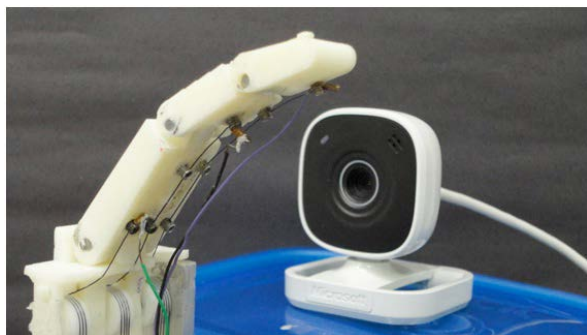
Figura 6 – Protótipo do dedo robótico com o sensor de posição
