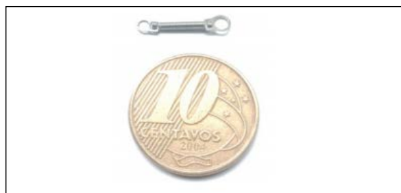
Figura 8 – Micro mola de LMF NiTi empregada como atuador no protótipo desenvolvido
