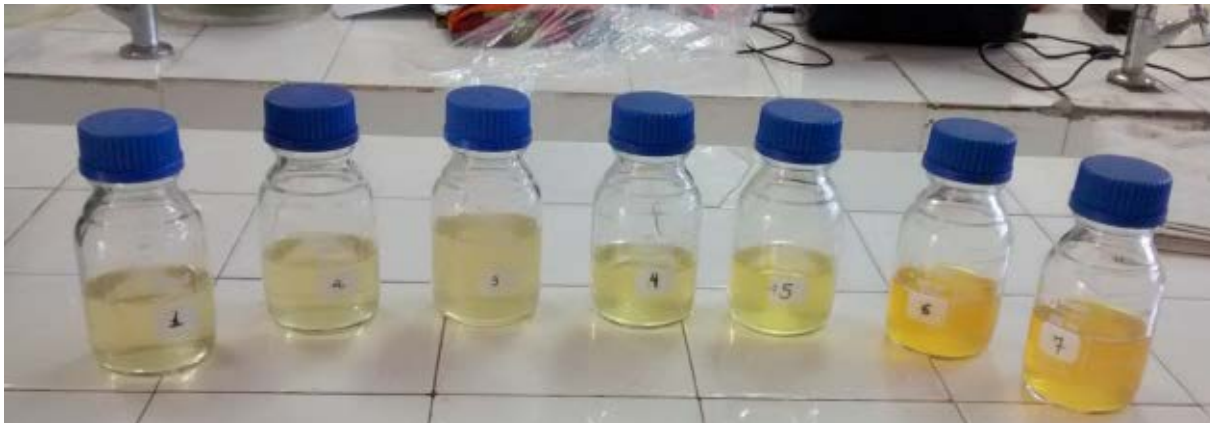
Figura 3 – Resultados com a confirmação da presença de coliformes totais em amostras de água utilizadas para consumo em sete escolas municipais da zona urbana do município de Esperança/PB, após a aplicação do reagente Colilert
