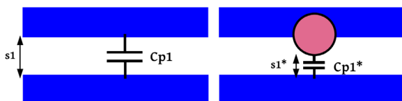
Figura 19 - Distância entre nets versus Probabilidade de mudanças nas capacitâncias (nets próximas)
