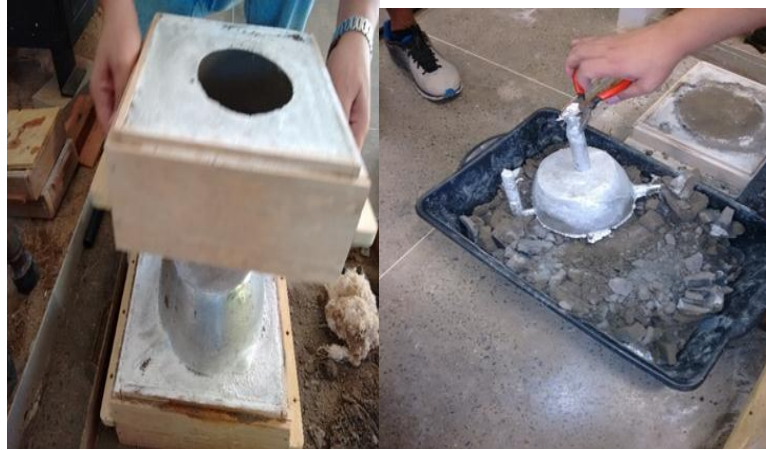
Figura 5 – Moldagem da panela em alumínio. Fonte: própria dos autores
