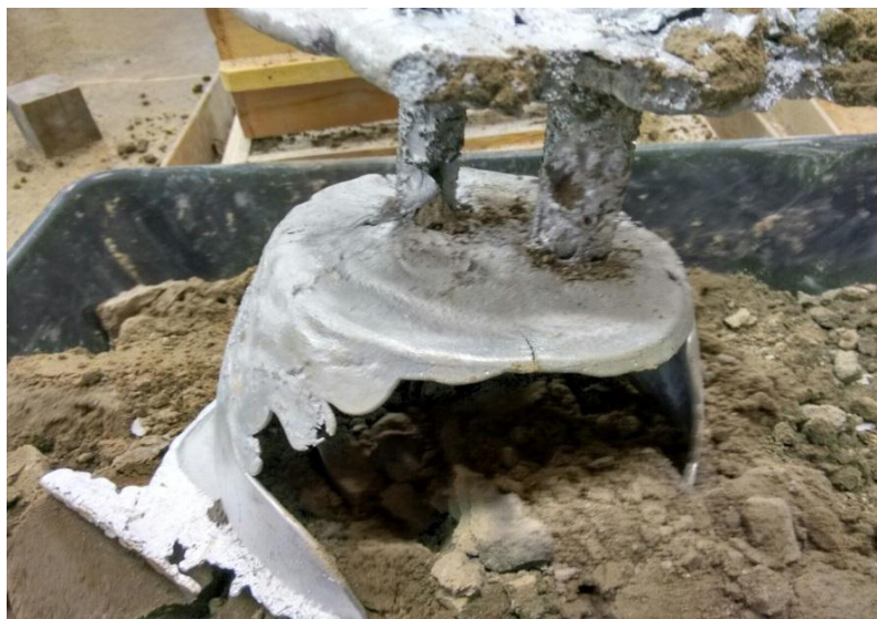
Figura 2 – Primeiras fundições de alumínio obtidas através de latinhas recicladas. Fonte: própria dos autores
