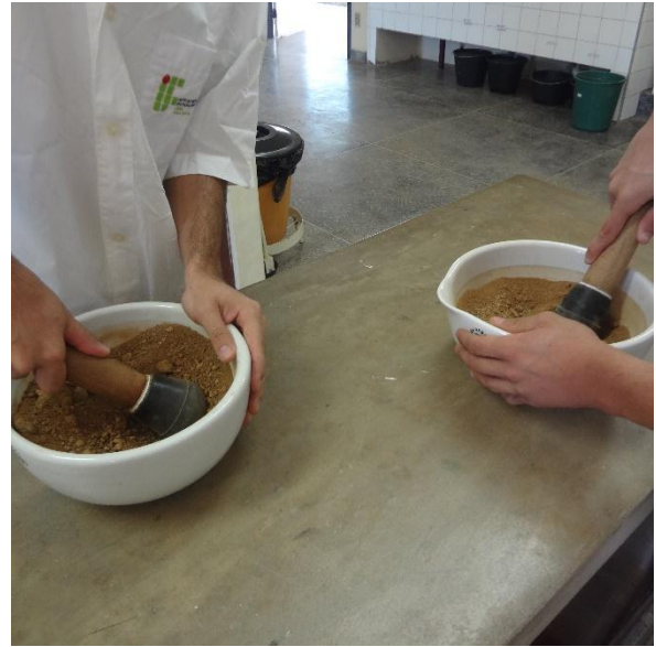
Imagem 2 – À esquerda, coleta de amostra de solo. À direita destorroamento do solo para realização de ensaios de caracterização.
