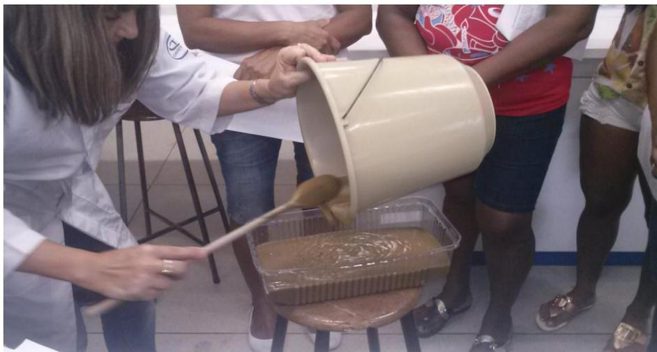
Figura 2. Etapa final do processo de fabricação do sabão. Fonte: IFPB, 2013
