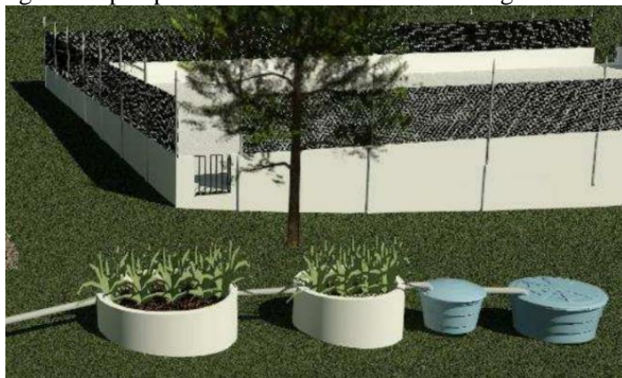
Figura 1 - Imagem em perspectiva do sistema de filtro biológico existente no CCA
