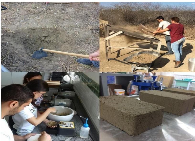
Figura 2 – Coleta, peneiramento, caracterização e fabricação dos tijolos de solo-cimento. Fonte: os autores
