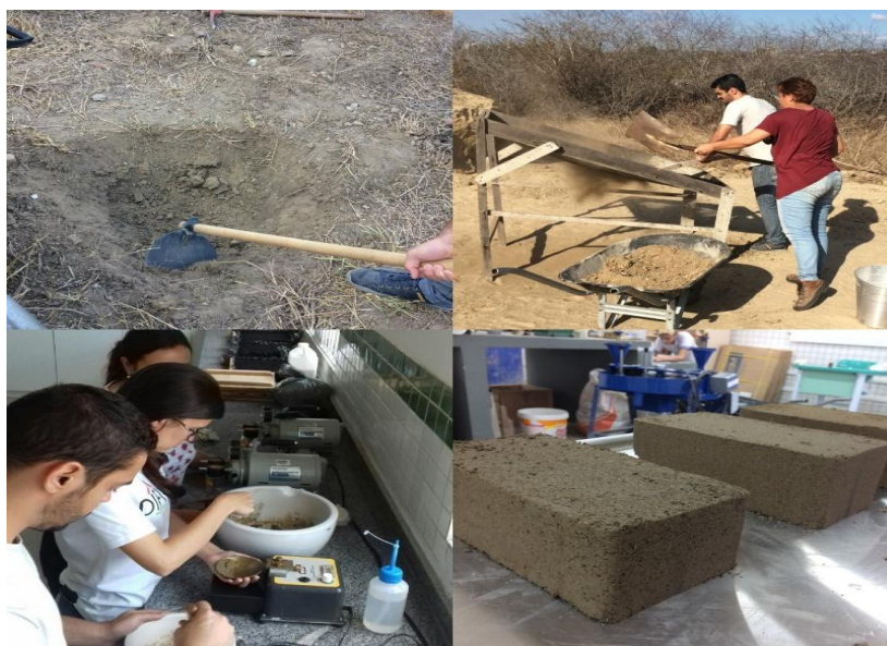
Figura 2 – Coleta, peneiramento, caracterização e fabricação dos tijolos de solo-cimento. Fonte: os autores
