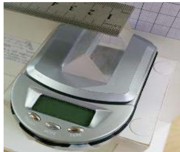
Figura 6 – Medição da reação de apoio com a balança.
