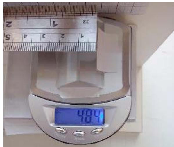
Figura 6 – Medição da reação de apoio com a balança.
